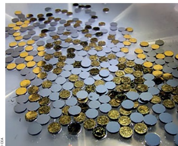
Figure 1 : électrodes en diamant dopé au bore fabriquées au CEA-List par dépôt chimique en phase vapeur assisté par plasma microonde.
